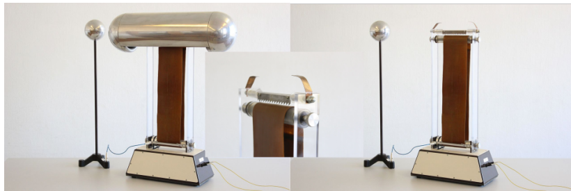
Figure 3: Generador de Van der Graaff
