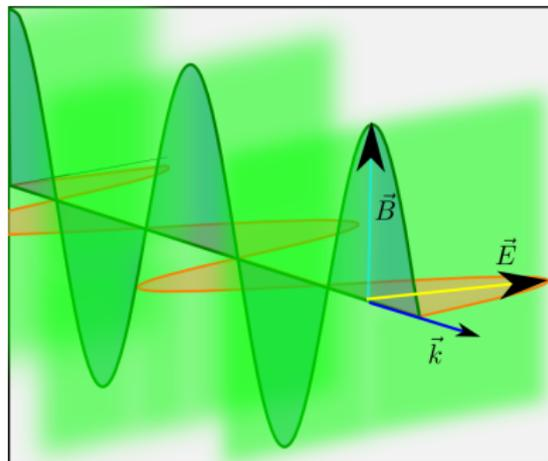
Ambos campos se propagan en fase, con polarizaciones perpendiculares entre sí y transversales a la dirección de propagación.
