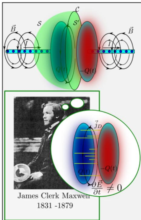
James C. Maxwell observó que  $S$  y  $S'$  forman una **superficie cerrada** y por lo tanto, según la **Ley de Gauss** y el **principio de conservación de la carga eléctrica**
