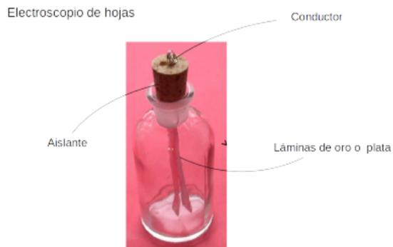
Figure 4: El electroscópio
