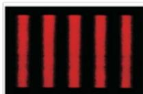
Patrón de interferencia obtenido con una fuente laser
