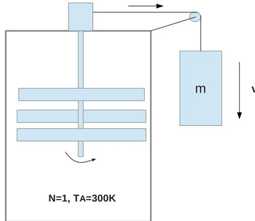
Figura 1: (Ejercicio 1) la masa  $m$  desciende y el movimiento se transmite por la soga y un mecanismo de engranajes a una paleta que agita al gas.
