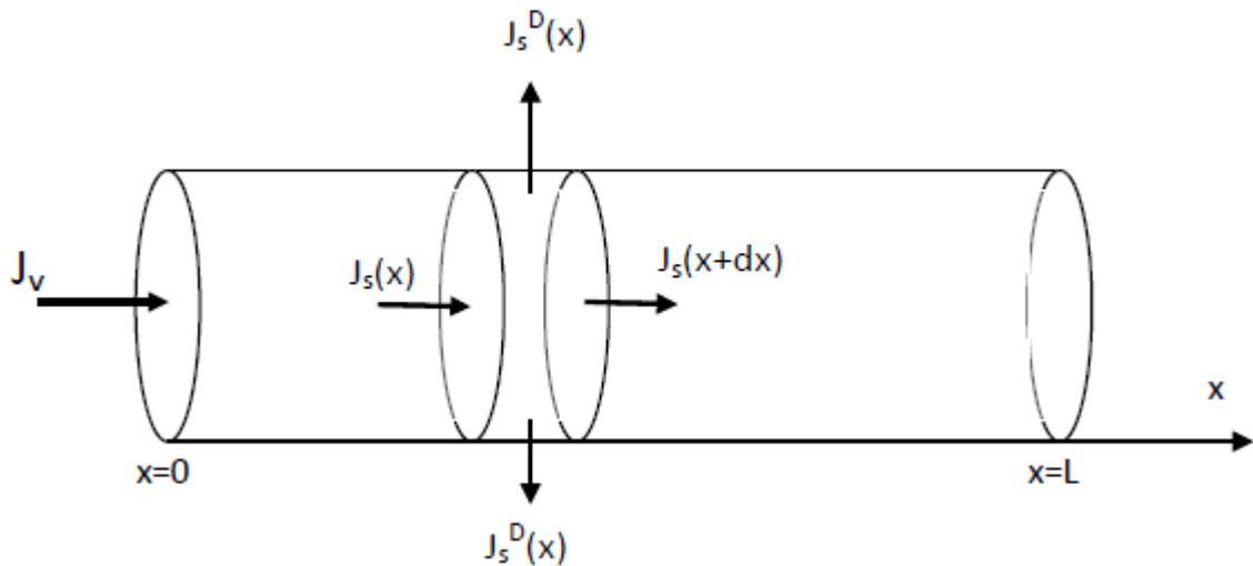
La figura muestra un esquema que utilizamos para escribir la ecuación de balance entre el soluto que entra y sale por unidad de tiempo de la lonja de grosor  $dx$  ubicada entre  $x$  y  $x+dx$ :
