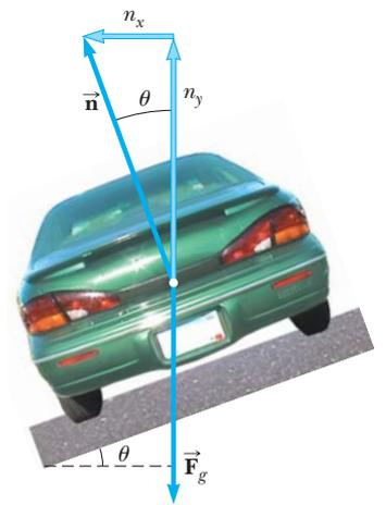
**Figura 6.5** (Ejemplo 6.4) Un automóvil que recorre una curva sobre un camino peraltado a un ángulo  $\theta$  con la horizontal. Cuando la fricción es despreciable, la fuerza que causa la aceleración centrípeta y mantiene al automóvil en movimiento en su trayectoria circular es la componente horizontal de la fuerza normal.
