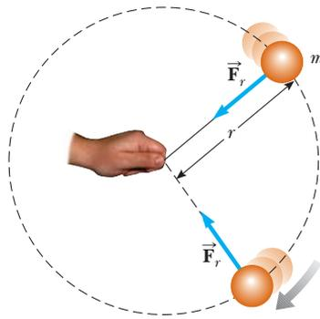
**Figura 6.1** Vista superior de una bola móvil en una trayectoria circular en un plano horizontal. Una fuerza  $\vec{F}_r$  dirigida hacia el centro del círculo mantiene a la bola móvil en su trayectoria circular.
