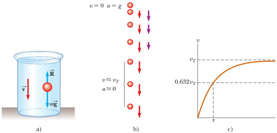
**Figura 6.13** a) Una pequeña esfera que cae a través de un líquido. b) Diagrama de movimiento de la esfera mientras cae. Se muestran los vectores velocidad (rojo) y aceleración (violeta) para cada imagen después de la primera. c) Gráfica rapidez-tiempo para la esfera. La esfera se aproxima a una rapidez máxima (o terminal)  $v_T$  y la constante de tiempo  $\tau$  es el tiempo en el que llega a una rapidez de  $0.632v_T$ .
