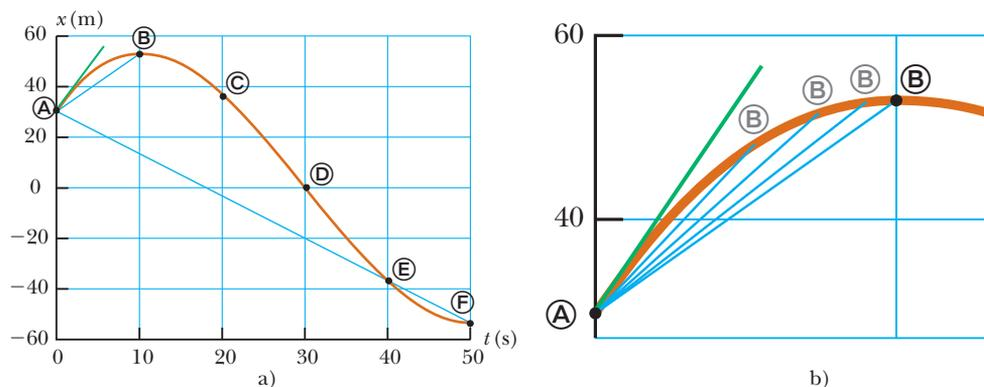
**Figura 2.3** a) Gráfica que representa el movimiento del automóvil de la figura 2.1. b) Una ampliación de la esquina superior izquierda de la gráfica muestra cómo la línea azul entre las posiciones A y B tiende a la línea tangente verde conforme el punto B se mueve más cerca del punto A.
