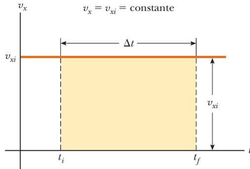
**Figura 2.16** Curva velocidad-tiempo para una partícula que se mueve con velocidad constante  $v_{xi}$ . El desplazamiento de la partícula durante el intervalo de tiempo  $t_f - t_i$  es igual al área del rectángulo sombreado.
