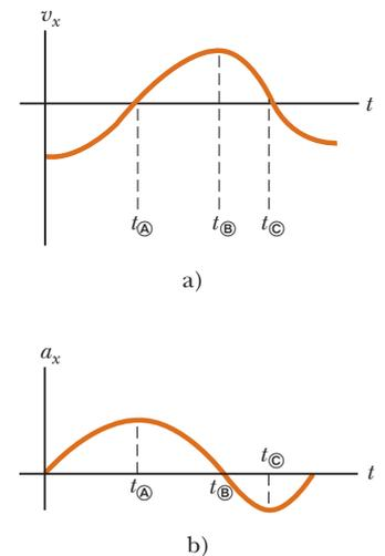
**Figura 2.7** La aceleración instantánea se obtiene de la gráfica velocidad-tiempo a). En cada instante, la aceleración en la gráfica de  $a_x$  en función de  $t$  b) es igual a la pendiente de la línea tangente a la curva de  $v_x$  en función de  $t$  a).
