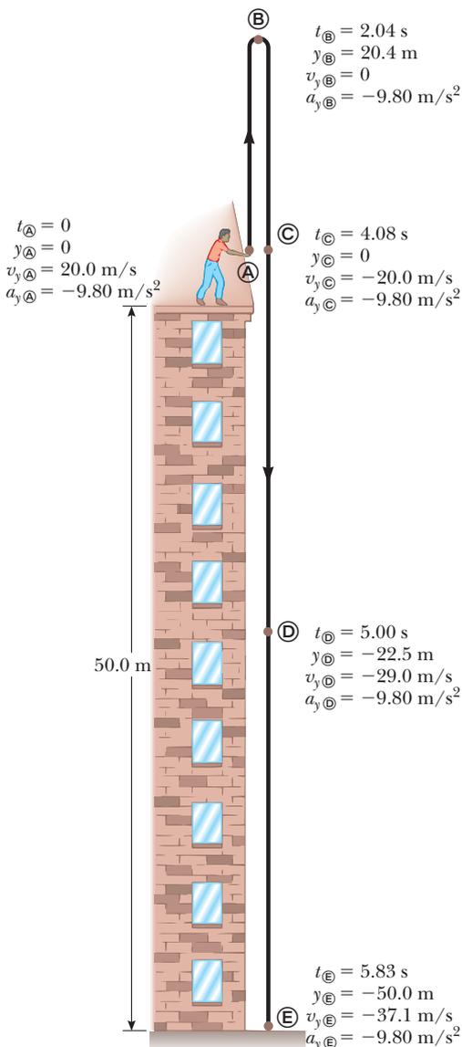
**Figura 2.14** (Ejemplo 2.10) Posición y velocidad frente a tiempo para una piedra en caída libre que se lanza inicialmente hacia arriba con una velocidad  $v_{yi} = 20.0$  m/s. Muchas de las cantidades en las etiquetas para los puntos en el movimiento de la piedra se calculan en el ejemplo. ¿Puede verificar los valores que no están calculados?
