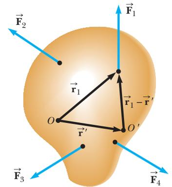
**Figura 12.4** Construcción que muestra: si el momento de torsión neto es cero en torno a un eje a través del origen  $O$ , también es cero en torno a un eje a través de cualquier otro origen, como  $O'$ .
