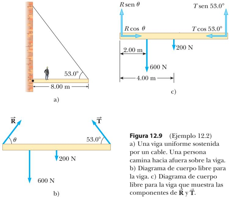
**Figura 12.9** (Ejemplo 12.2) a) Una viga uniforme sostenida por un cable. Una persona camina hacia afuera sobre la viga. b) Diagrama de cuerpo libre para la viga. c) Diagrama de cuerpo libre para la viga que muestra las componentes de  $\vec{R}$  y  $\vec{T}$ .
