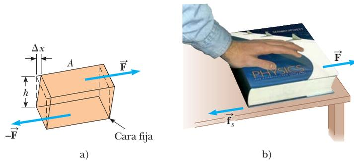
**Figura 12.14** a) Una deformación de corte en la que un bloque rectangular se distorsiona mediante dos fuerzas de igual magnitud pero direcciones opuestas aplicadas a dos caras paralelas. b) Un libro está bajo esfuerzo de corte cuando una mano que se coloca en la cubierta aplica una fuerza horizontal que se aleja del lomo.
