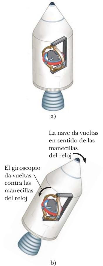
**Figura 11.15** a) Una nave espacial porta un giroscopio que no gira. b) Cuando el giroscopio se pone en rotación, la nave gira al otro lado de modo que la cantidad de movimiento del sistema se conserva.
