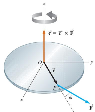
**Figura 11.1** El vector momento de torsión  $\vec{\tau}$  se encuentra en una dirección perpendicular al plano formado por el vector de posición  $\vec{r}$  y el vector fuerza aplicada  $\vec{F}$ .
