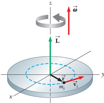
**Figura 11.7** Cuando un objeto rígido da vueltas en torno a un eje, la cantidad de movimiento angular  $\vec{L}$  está en la misma dirección que la velocidad angular  $\vec{\omega}$ , de acuerdo con la expresión  $\vec{L} = I\vec{\omega}$ .
