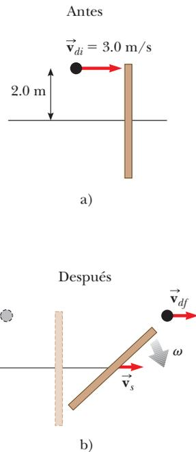
**Figura 11.12** (Ejemplo 11.9) Vista superior de un disco que golpea un bastón en una colisión elástica. a) Antes de la colisión, el disco se mueve hacia el bastón. b) La colisión hace que el bastón dé vuelta y se mueva a la derecha.
