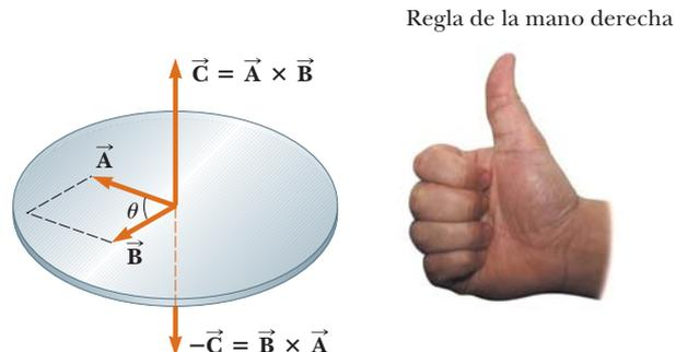
**Figura 11.2** El producto vectorial  $\vec{A} \times \vec{B}$  es un tercer vector  $\vec{C}$  que tiene una magnitud  $AB \sin \theta$  igual al área del paralelogramo que se muestra. La dirección de  $\vec{C}$  es perpendicular al plano formado por  $\vec{A}$  y  $\vec{B}$  y esta dirección está determinada por la regla de la mano derecha.
