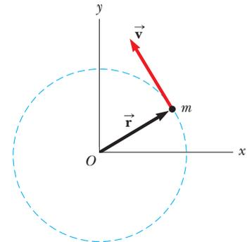
**Figura 11.5** (Ejemplo 11.3) Una partícula móvil en un círculo de radio  $r$  tiene una cantidad de movimiento angular en torno a un eje a través de  $O$  que tiene magnitud  $mvr$ . El vector  $\vec{L} = \vec{r} \times \vec{p}$  apunta hacia afuera de la página.
