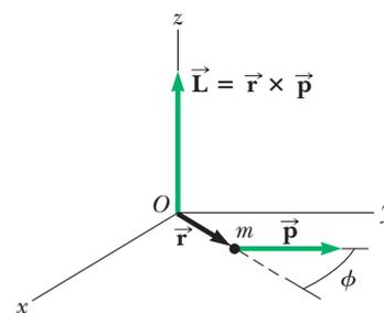
**Figura 11.4** La cantidad de movimiento angular  $\vec{L}$  de una partícula con cantidad de movimiento lineal  $\vec{p}$  ubicada en la posición vectorial  $\vec{r}$  es un vector conocido por  $\vec{L} = \vec{r} \times \vec{p}$ . El valor de  $\vec{L}$  depende del eje en torno al que se mida y es un vector perpendicular tanto a  $\vec{r}$  como a  $\vec{p}$ .
