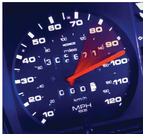
Figura 1.3 Indicador de velocidad de un vehículo que muestra magnitudes de velocidad tanto en millas por hora como en kilómetros por hora.
