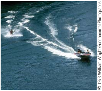
Figura 17.11 La onda de proa con forma en V de un bote se forma debido a que la rapidez del bote es mayor que la rapidez de las ondas del agua que genera. Una onda de proa es análoga a una onda de choque formada por un avión que viaja más rápido que el sonido.
