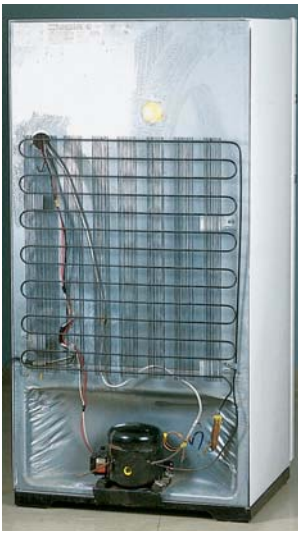
Figura 22.6 Los serpentines en la parte trasera de un refrigerador transfieren energía por calor al aire. Debido a la entrada de energía por trabajo, esta cantidad de energía debe ser mayor que la cantidad de energía removida de los contenidos del refrigerador.
