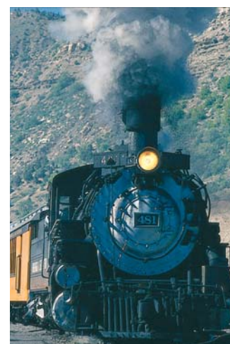
Figura 22.1 Esta locomotora impulsada por vapor corre de Durango a Silverton, Colorado. Obtiene su energía mediante la quema de madera o carbón. La energía generada vaporiza agua, que impulsa la locomotora. (Esta locomotora debe tomar agua de tanques ubicados a lo largo de la ruta para sustituir la pérdida de vapor a través de la chimenea.) Las locomotoras modernas usan combustible diesel en lugar de madera o carbón. Ya sean antiguas o modernas, tales locomotoras se modelan como máquinas térmicas, que extraen energía de la quema de un combustible y convierten una fracción del mismo en energía mecánica.
