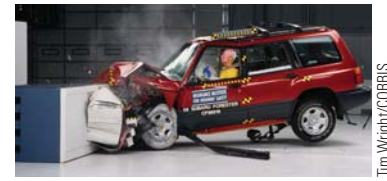
Figura 9.4 (Ejemplo 9.3) a) La cantidad de movimiento de este automóvil cambia como resultado de su colisión con la pared. b) En una prueba de choque, mucha de la energía cinética inicial del automóvil se transforma en energía asociada con el daño al auto.
