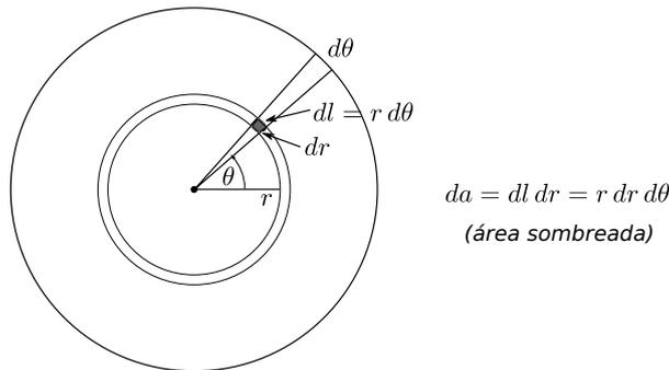
$I_{CM}$ : para resolver el momento de inercia respecto del CM conviene usar coordenadas polares, como en la figura. Un elemento de área infinitesimal se escribe  $da = r dr d\theta$ . Para sumar sobre todo el disco se debe recorrer  $r$  entre 0 y  $R$ , y  $\theta$  entre 0 y  $2\pi$ . Con esos elementos el momento de inercia se calcula como
