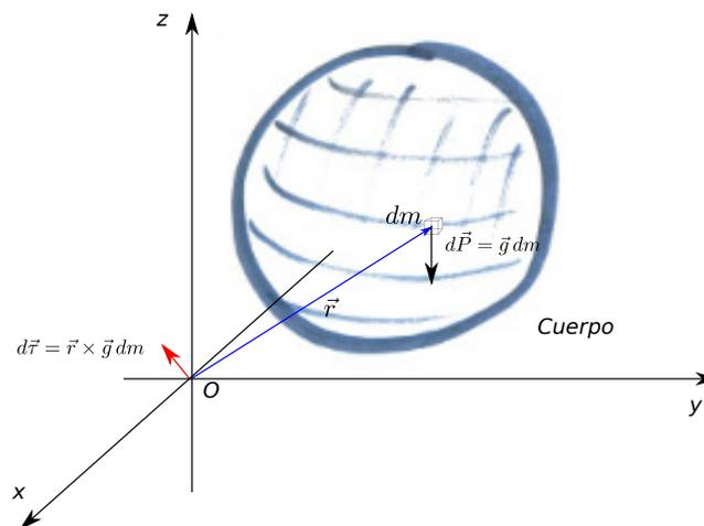
Calculemos el torque total de la fuerza gravitatoria respecto de  $O$ , usando el modelo continuo: tenemos que sumar los torques infinitesimales  $d\vec{\tau} = \vec{r} \times (dm \vec{g})$
