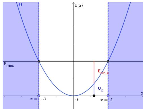
Dado que la parábola es simétrica, los puntos de retorno se hallan a igual distancia del origen. Esta distancia  $A > 0$  se llama *amplitud* del movimiento oscilatorio.
