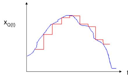
Tiempo continuo, amplitud discreta. La amplitud solo toma determinados valores.
